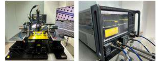
종래 50GHz 대역으로 부터 110GHz 대역 확장 측정 환경 구축
