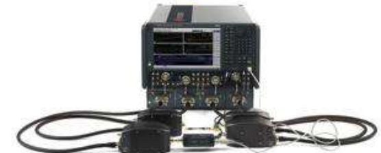
최대 80GHz 대역의 성능 평가를 위한 110GHz 측정 환경 구축
